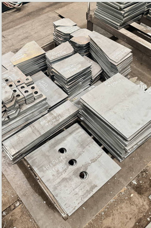
— Фасонки и рёбра после плазменного раскроя
