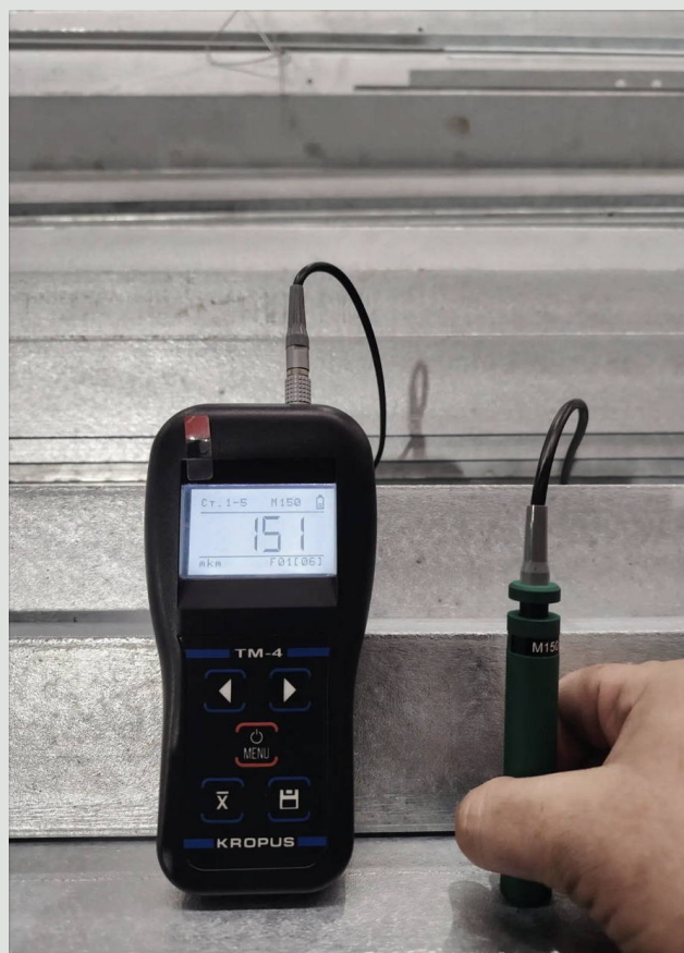
— Замер покрытия на оцинкованном профиле
