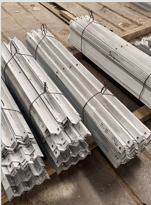
— Конструкции увязаны в пачки и промаркированы под отгрузку
