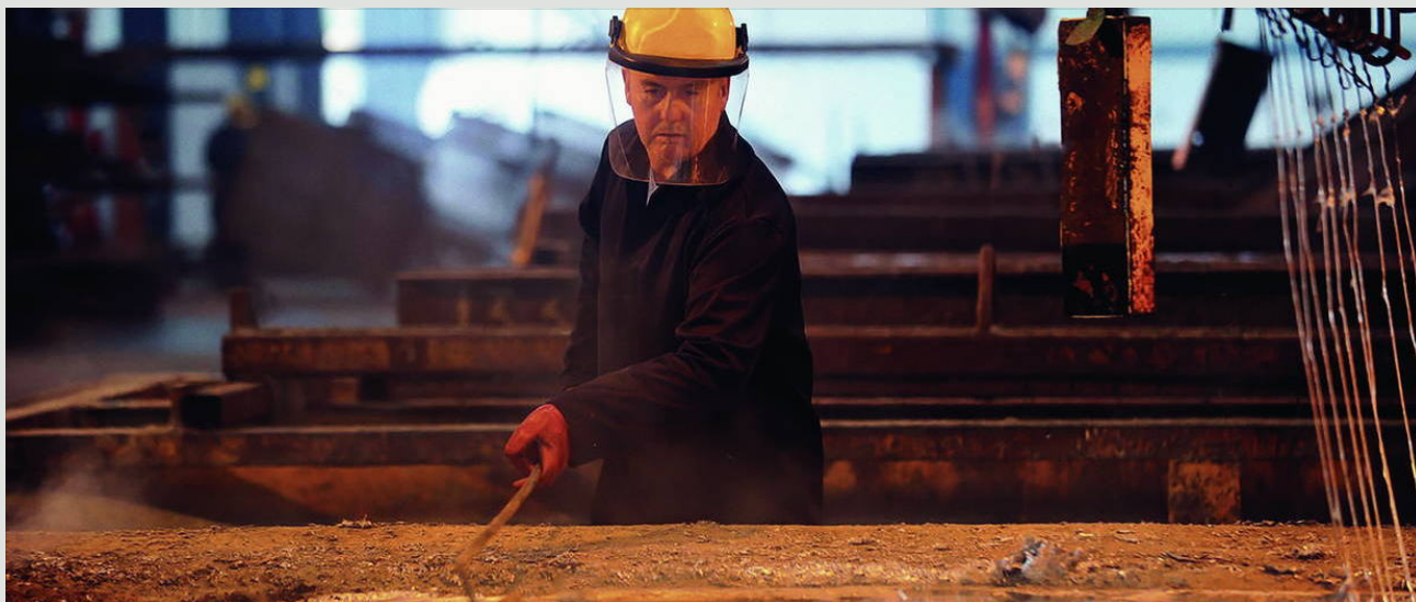
— Горячее цинкование: погружение в расплав цинка
