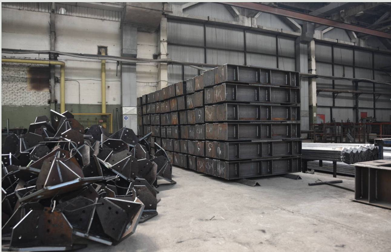
— Складирование металлоконструкций: фасонки и сварные секции
