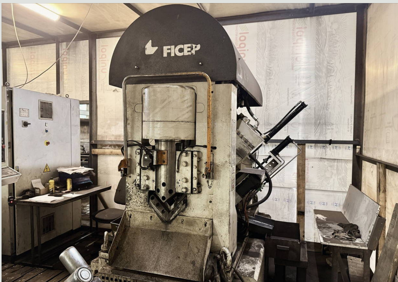
— Автоматическая линия обработки уголка FICER
